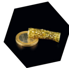
Matériau biosourcé réalisé conjointement par Aerial et l'IPHC par irradiation de gels de protéines
